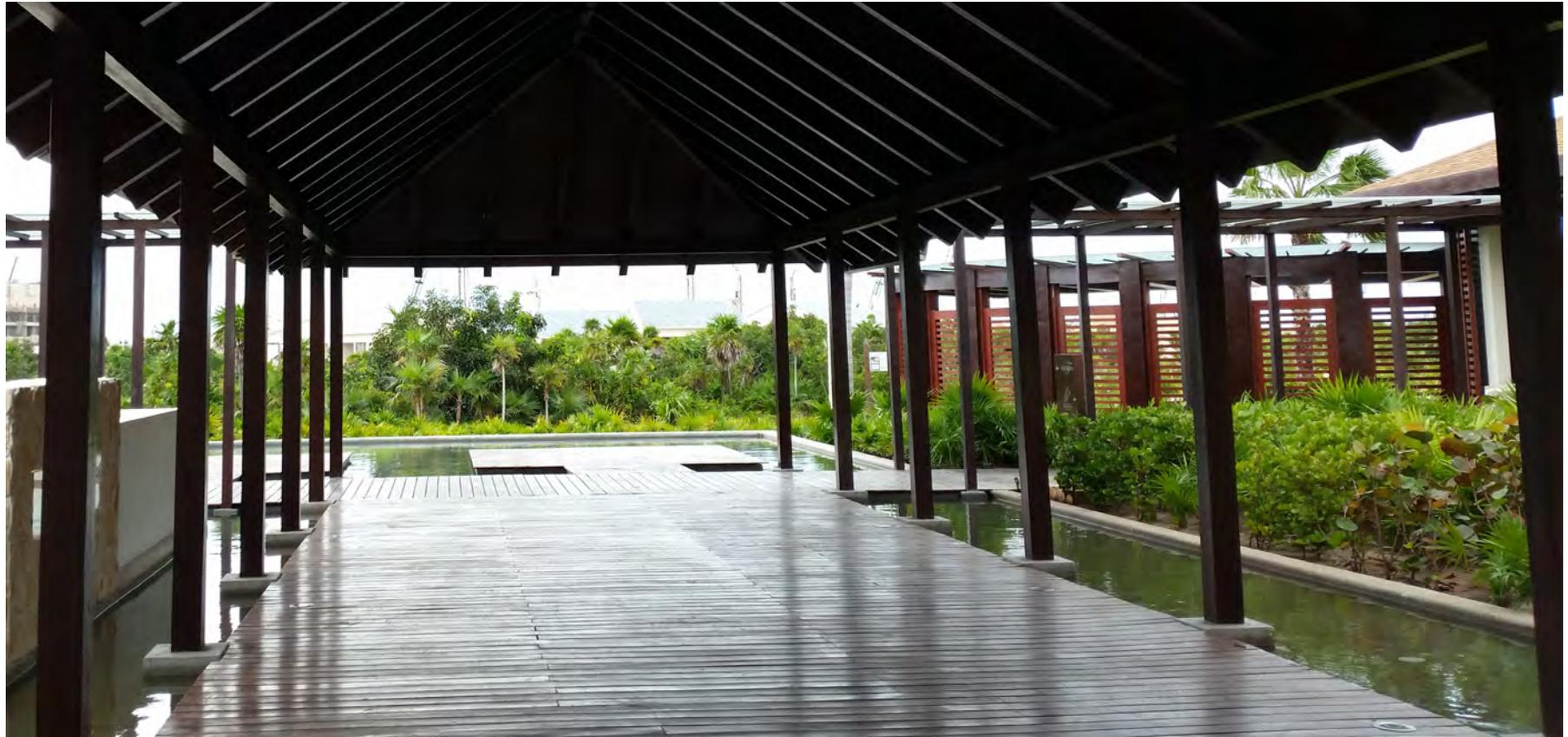
Palapa con estructura metálica en fibra de vidrio y cubierta en GFRG acabado madera
